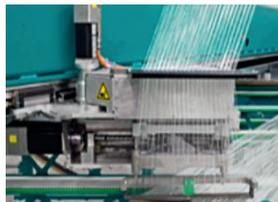
b) Portador para desenredar los hilos no prensados
