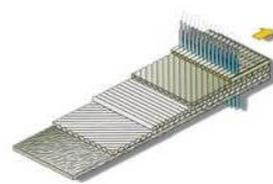
c) Aspecto de las capas, con una capa de fibras cortada en la parte superior
