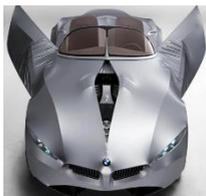
**Fig. 1.4.23** Coche conceptual de BMW GINA usa Lycra estirada sobre un bastidor de aluminio
