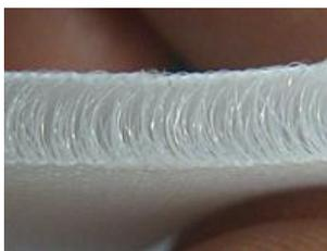
**Figura 2.4.9.** Tejido espaciador – sección transversal
