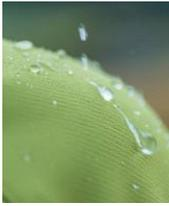
**Fig. 1.4.7** Ecoperl-acabado líquido biomimético y repelente de suciedad.
