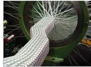
**Figura 1.5.16.** Estructura trenzada triaxial con forma geométrica [12]
