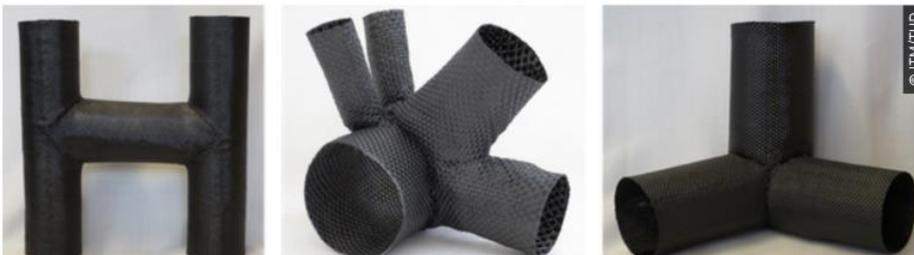
**Figura 1.5.11.** Ejemplos de estructuras 3D de calada nodales [7]
