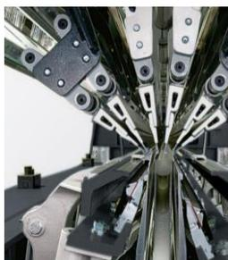
**Figura 2.4.8.** Máquina de doble barra – elementos de punto
