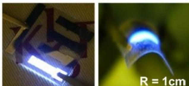
**Figura 2.3.12.** Emisión de luz azul desde dispositivos de estructura textil/LED/textil y después de la reflexión (radio de curvatura:  $R=1$  cm) [20]
