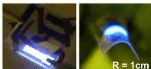
**Figura 2.3.12.** Dispositivi di emissione di luce blu dal tessuto/LED/struttura tessile e dopo la piegatura (con un raggio di curvatura  $R = 1\text{ cm}$ ) [20]
