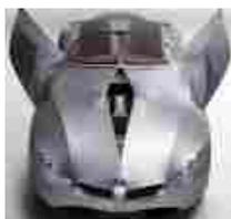
**Fig. 1.4.23** BMW concept car GINA utilizza Lycra tesa su di un telaio in alluminio
