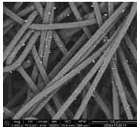
**Figura 2.5.3.** Esempio di AgNPs sulla fibra di poliestere prima e dopo trattamento al plasma DBD
