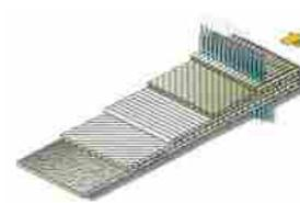
C) Aspetto degli strati, con un mat di fibre tagliate nella parte inferiore
